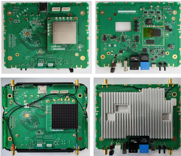
그림 14. 5G sub-6 GHz 지원 단말 PBA 형상
