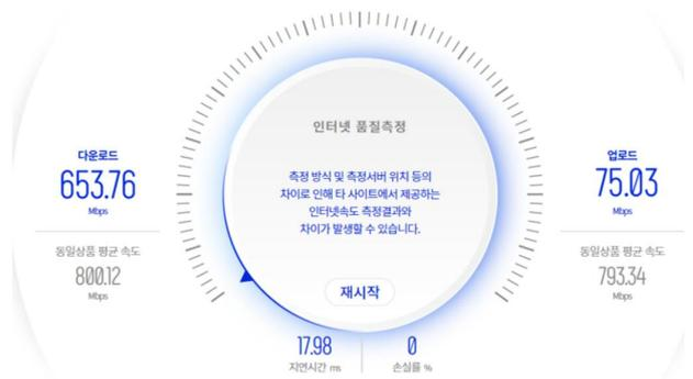
그림 19. 5G 3.5 GHz 접속 최대 전송 속도 측정 결과
