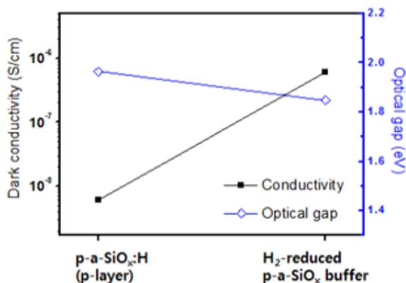
그림 1 제작된 신규 수소 저감형 비정질 실리콘 산화막 버퍼층(H<sub>2</sub>-reduced p-a-SiO<sub>x</sub> buffer)의 전도도와 광학적 밴드갭 특성 (일반적인 p-layer 와의 비교)
