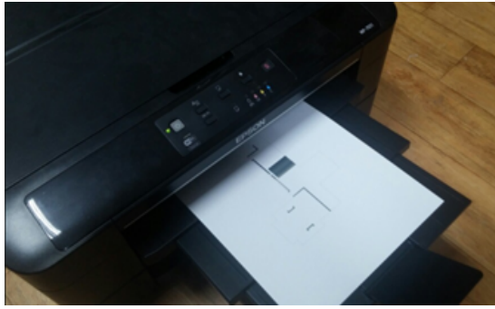
그림 5. EPSON WF-7011 프린터를 이용한 제안된 안테나의 인쇄모습
