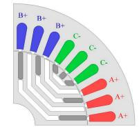
Figure 13. Final model of LS-SynRM.
