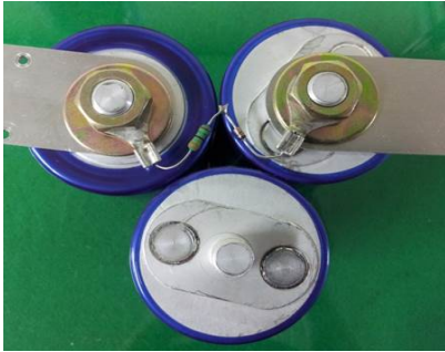
그림 9. 제안한 Passive 밸런싱 적용한 사진 Fig. 9. Proposed passive balancing
