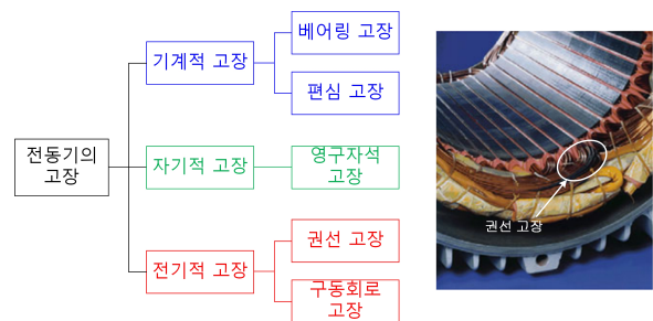
그림 1 전동기 고장 종류 Fig. 1 Type of motor fault
