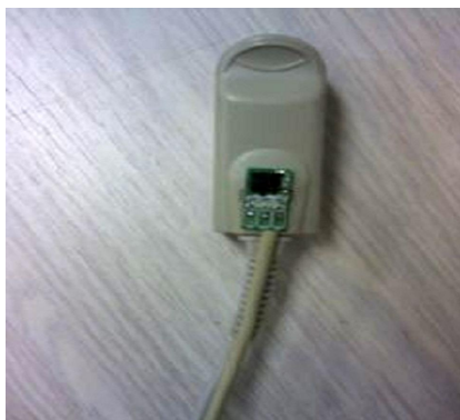
그림 1. 광전용맥파 센서 및 가속도계 Fig. 1. Photoplethysmography sensor and accelerometer
