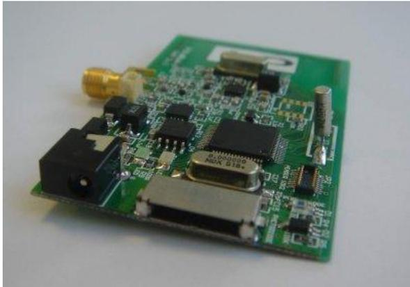
그림 8(a) Sensor Node
