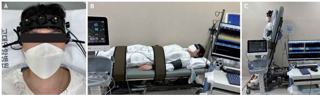
(A) 머리에 TCD 장비를 부착 (B) 기립경사 검사에서 누운(양와위) 상태 동안 심박수, 혈압 및 뇌혈류 모니터링함 (C) 기립경사 검사 중 약 70도 정도로 기울인 상태에서 모니터링 수행
